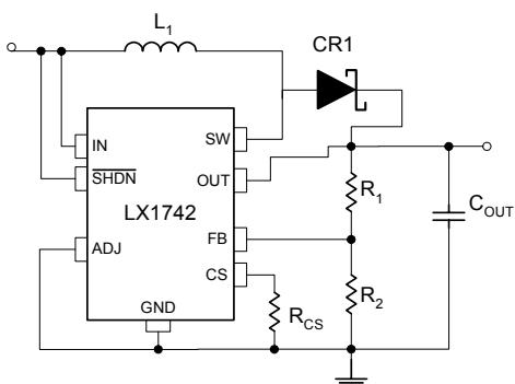
FIGURE 2 – TYPICAL LX1742 APPLICATION CIRCUIT
