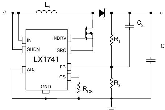
FIGURE 1 – TYPICAL LX1741 APPLICATION CIRCUIT
