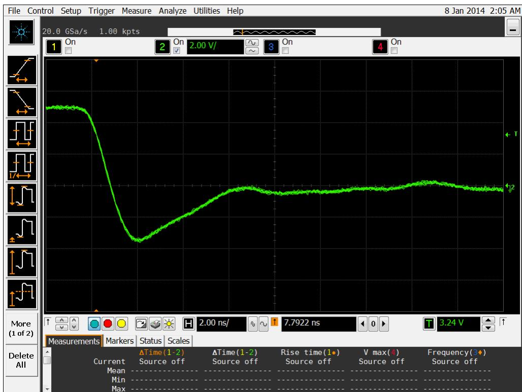
Figure 15b DUT 5608 Post-Annealing Falling Edge
