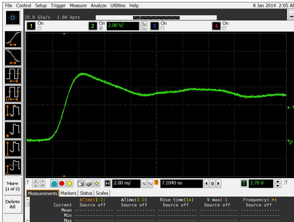
Figure 10b DUT 5608 Post-Annealing Rising Edge
