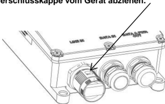
**Schritt 4:** Installations vorschritt des Wechselstromkabels
