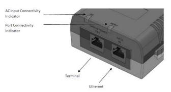
Abbildung 1: Anschliessen des PoE Midspans
