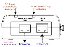
Abbildung 3: Anschluss des PoE Midspans
