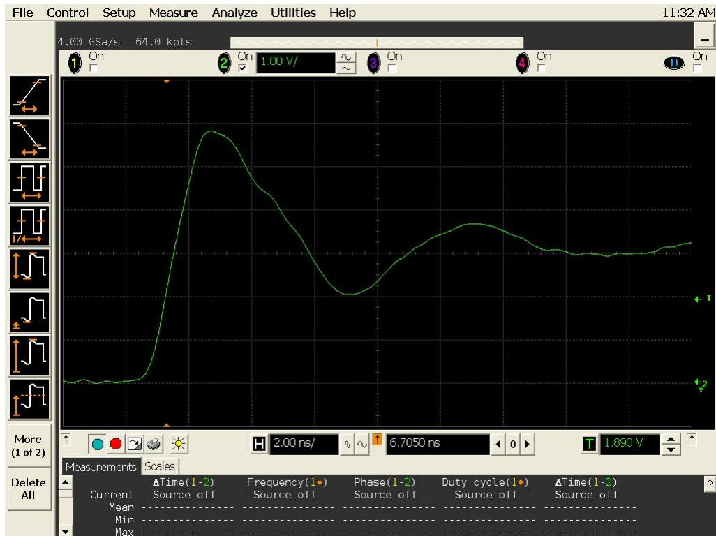
Figure 13b DUT 5814 Post-Annealing Rising Edge
