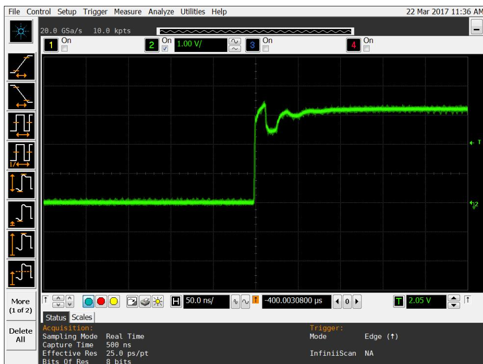
Figure 13b DUT 9434 Post-Annealing Rising Edge
