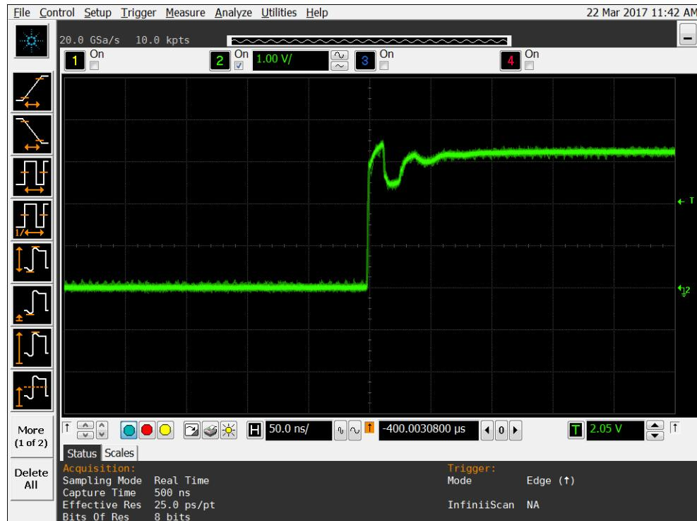
Figure 12b DUT 9416 Post-Annealing Rising Edge
