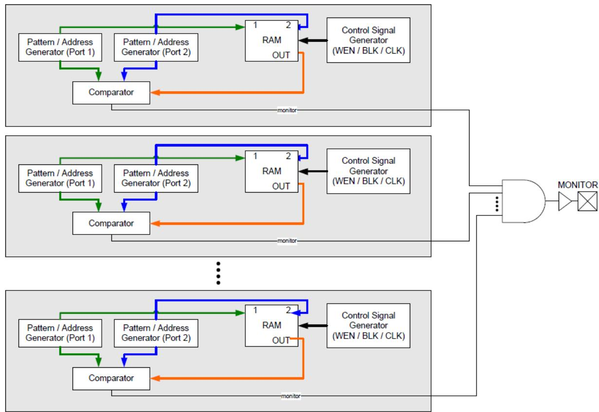
Fig. 30. Embedded Ram Blocks
