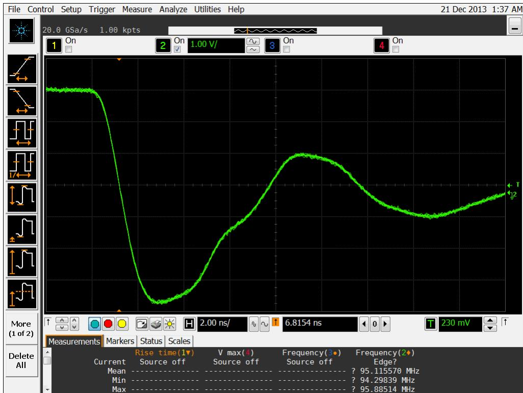
Figure 15b DUT 6121 Post-Annealing Falling Edge
