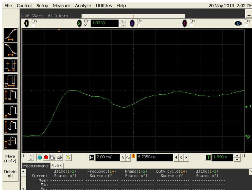
Figure 13b DUT 4395 Post-Annealing Rising Edge
