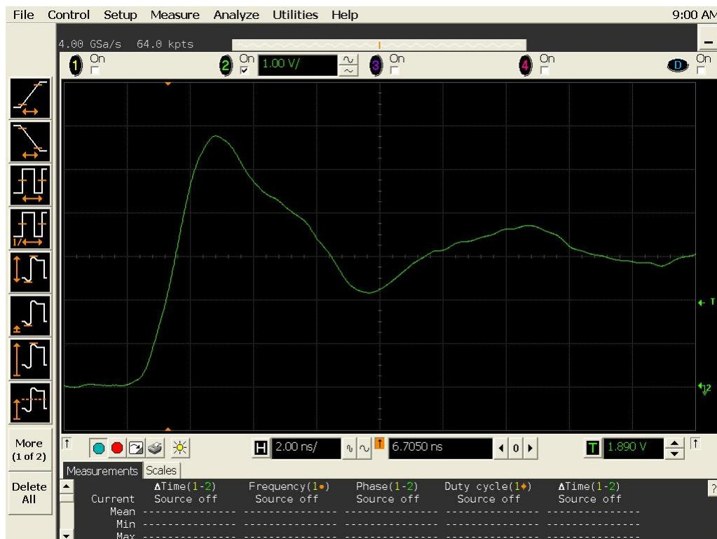
Figure 13b DUT 19718 Post-Annealing Rising Edge
