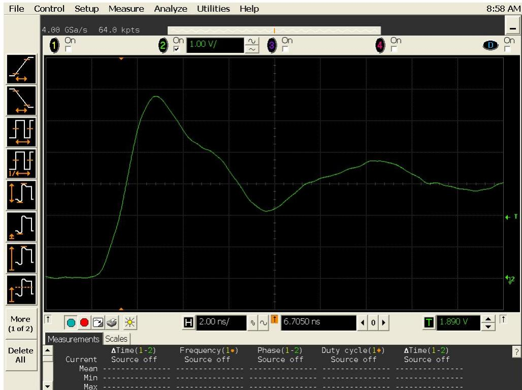
Figure 12b DUT 19712 Post-Annealing Rising Edge
