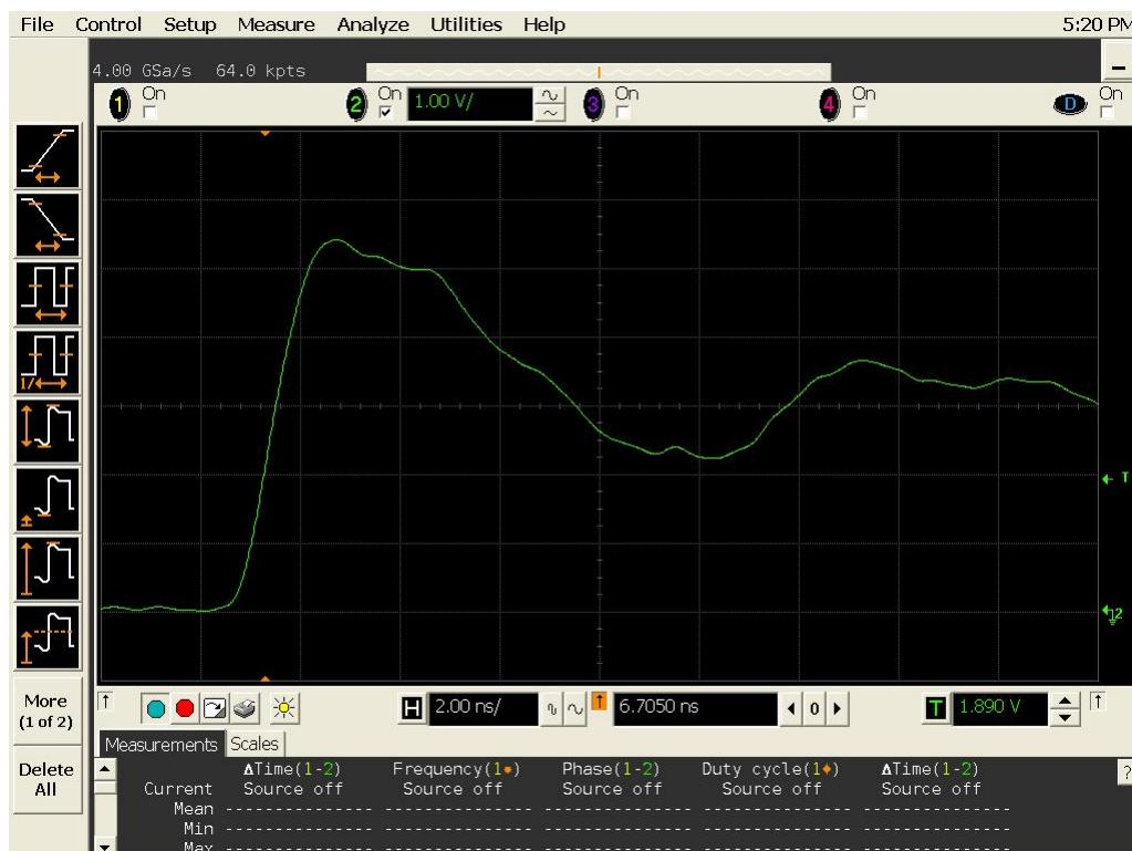
Figure 13b DUT 702 Post-Annealing Rising Edge
