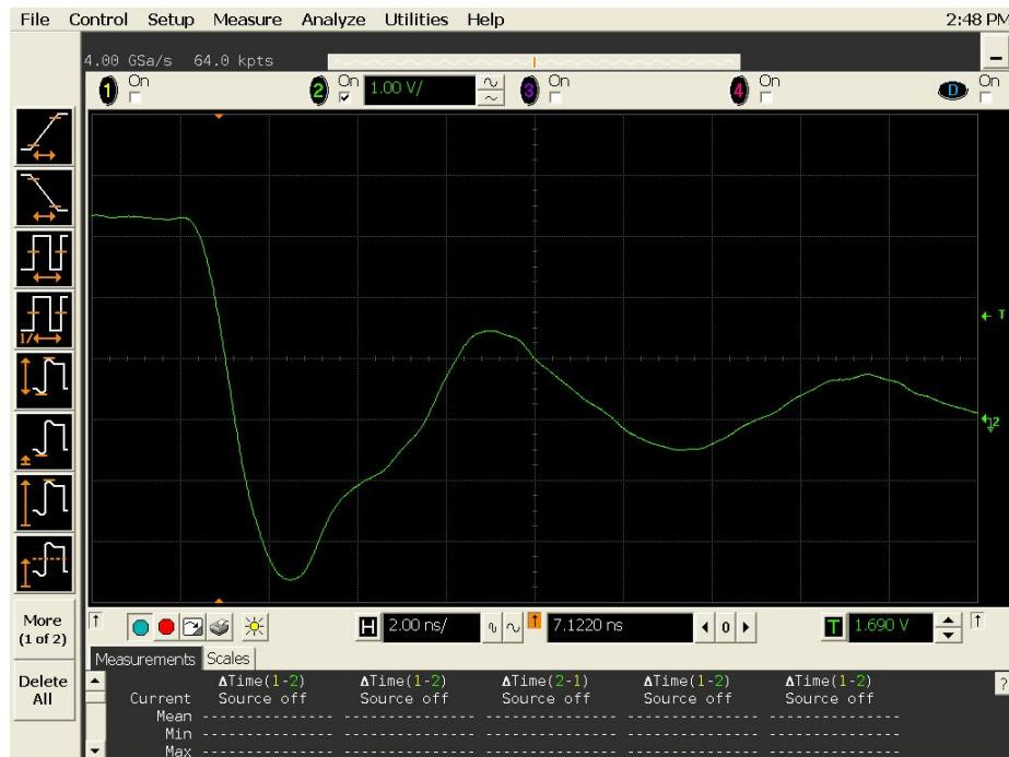
Figure 15b DUT 3007 Post-Annealing Falling Edge
