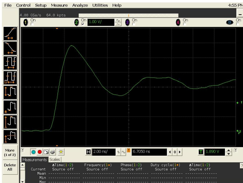
Figure 10b DUT 5319 Post-Annealing Rising Edge
