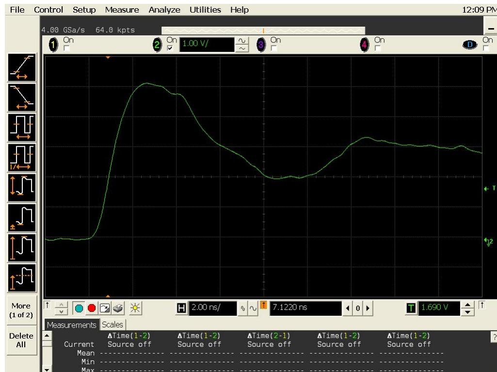
Figure 10b DUT 683 Post-Annealing Rising Edge
