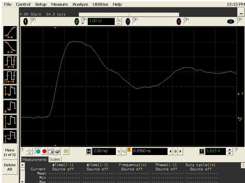
Figure 13b DUT 737 Post-Annealing Rising Edge
